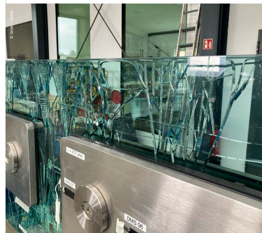
Zugversuche in Naturgröße im Labor LSL in Kissing bei Augsburg
